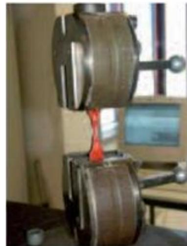
促進老化後のHDPEステープパイプサンプルへの張力試験
