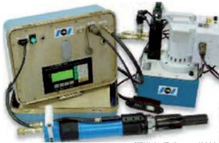
ストランド応力機(AMS)システムは自動制御と緊張作業の記録、緊張作業データの管理を提供します。このシステムにより、求められるケーブル力またはケーブル伸び率を達成するための緊張作業パラメーターを自由自在に決定できます。
