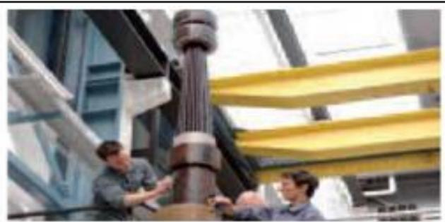
気密試験の後の6-37アンカレッジ検査。機械的及び環境的ストレスにさらすために、圧力水頭3mの染料溶液に浸される。
