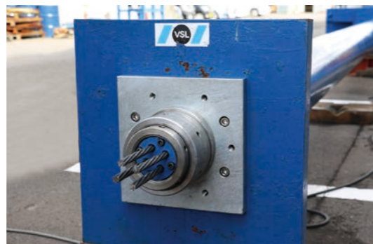
② クリアランスプレートの取付
