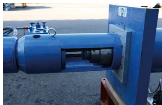
② 目標荷重まで載荷し回転棒にて外・内リングナットともに締める
