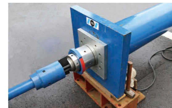
① ブルロッドをブルカップラーにスバナを使用して根元までねじ込む
