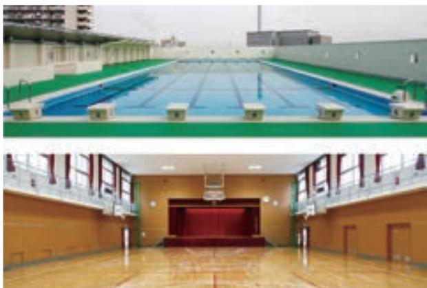
屋上にプールがあり高荷重であるにもかかわらず、下は体育館として使用するために現場打ちPC梁を採用して、スパン18.9mの空間を実現しています。敷地の狭い住宅街で、多く採用されています。
