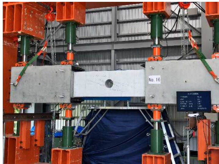
有開口 P C 梁実験
