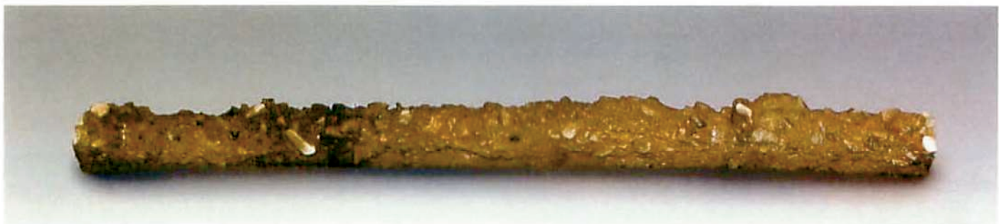
提出したアンカー体
