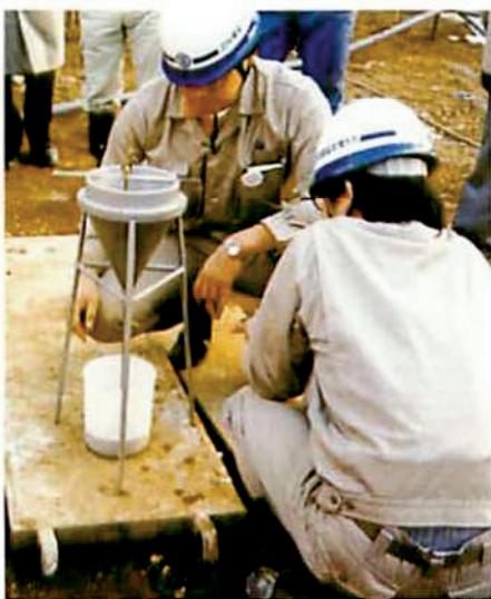
グラウト材の試験
